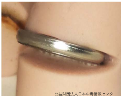
ソーセージに切り目を入れ、 新品のコイン形リチウム電池(3V)をはさむ。
